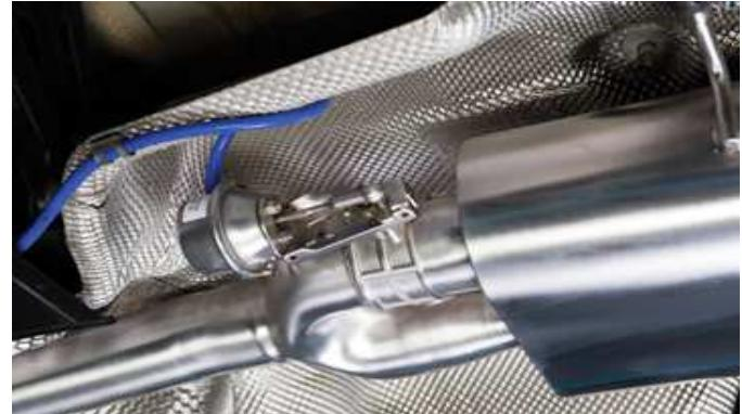
🇪🇸 Con el tubo de goma en dotación, conectar la salida del valvula electro-magnética con la valvula neumática de depresión.
